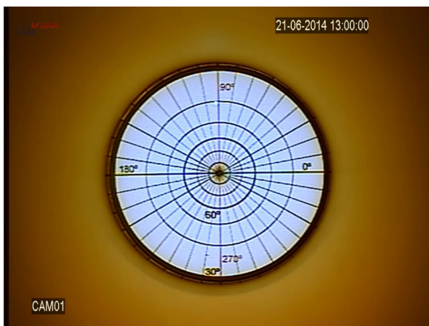
Figura 5.5 - Dia 21 de junho de 2014 às 13 horas com imagem do Sol (Elevação 41° Azimute 92°).
